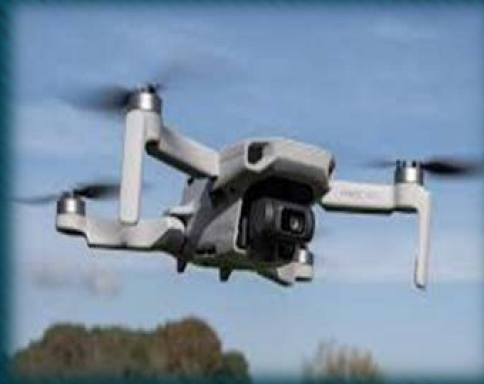
51 S.A.P.R. Mavic Mini Velocità max. 16 m/s Autonomia 25 min.
