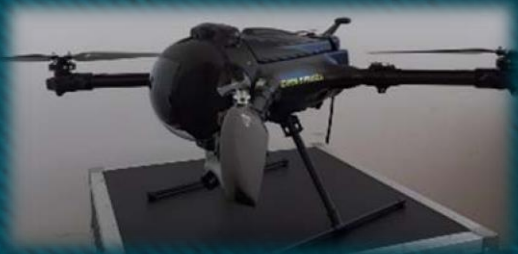
30 S.A.P.R. Colibrì Velocità max. 16 m/s Autonomia 45 min
