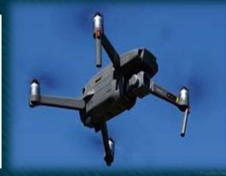
14 S.A.P.R. Mavic 2 Velocità max. 16 m/s Autonomia 45 min
